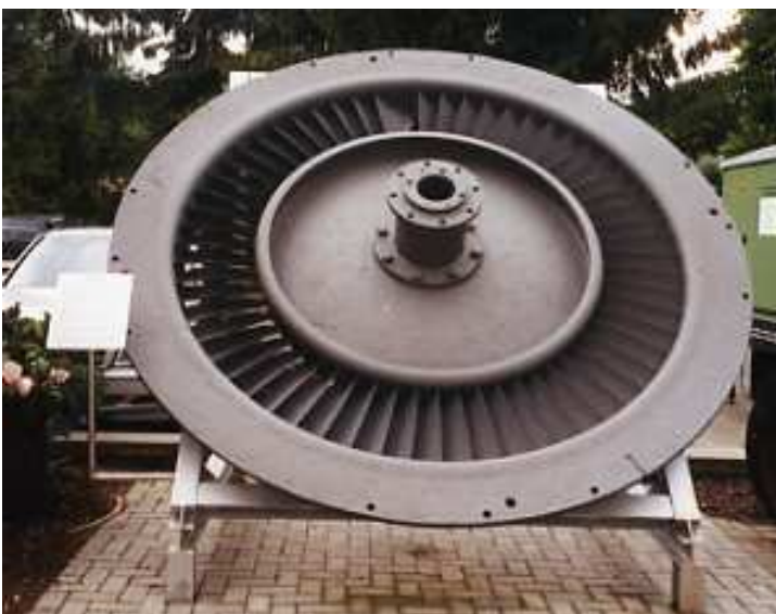
Bild 3: Leitbeschaufelung für eine der vier Wasserturbinen der Neuen Mühle (1890/91 erstes E-Werk und erste Pumpstation für die Trinkwasserversorgung der Stadt Cassel); Hersteller der Turbinen eine Eisengießerei und Maschinenfabrik in Gotha, der Pumpen eine Firma im damals ebenfalls preußischen Hannover.
