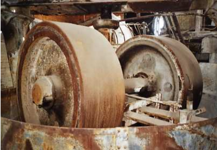
Bild 4: Kollergang der Ziegelei (bzw. des Ziegeleimuseums) Kaufungen. Antrieb durch Elektromotor über Zahnradgetriebe.
